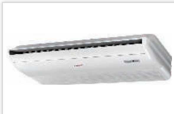
Refsystem, Klimatyzatory CONVERTIBLE. Typ: jednostki przysufitowo-przypodłogowe. Wydajność: od 3,5 do 15,5 kW. Cechy szczególne: ultracienka jednostka o grubości 199 mm zapewnia oszczędność zajmowanej powierzchni oraz możliwość dopasowania do wyposażenia mieszkania. Duży kąt nawiewu powietrza (kąt żaluzji 100° i kąt łopatek 70°) zapewnia jego dopych do każdego zakątka pomieszczenia.
