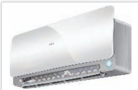
Refsystem, Klimatyzatory AQUA. Typ: jednostki do montażu na ścianie. Wydajność: od 2,6 do 3,5 kW. Cechy szczególne: generator nanocząsteczek, cienka konstrukcja, trójwymiarowy panel, filtr przeciwpleśniowy, niski poziom hałasu, tryb power, tryb soft. Zakres pracy: chłodzenie od -10 do 46°C, grzanie od -15 do 24°C.
